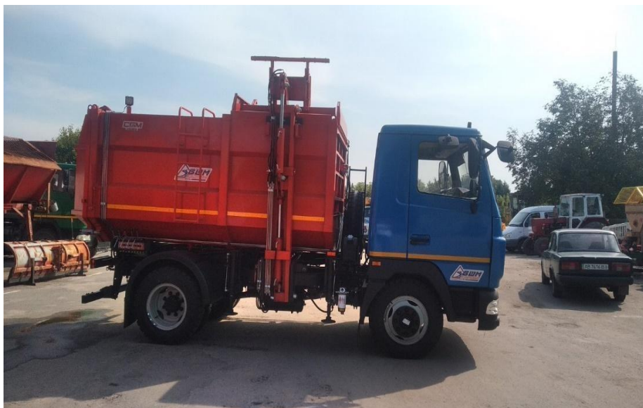
Рис. 22. Сміттєвоз з боковим завантаженням для механізованого завантаження побутових відходів. Джерело: Хмільницька міська рада
